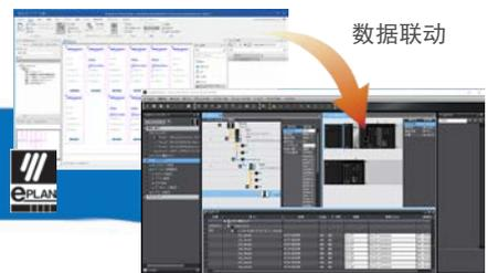
将使用电气CAD设计的回路图（各单元配置及信号线名称等）加载到Sysmac Studio中，会自动反映在单元配置设置和分配变量中。通过与电气CAD的设计数据联动并实现无缝且无差错的设置，可以削减作业工时并提高设计效率。
