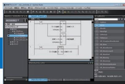
综合开发环境SysmacStudio符合国际标准IEC 61131-3（以及JIS B 3503）。使用“变量”进行编程，无需了解PLC供应商特定的存储器映射，并且程序可以轻松再利用。
