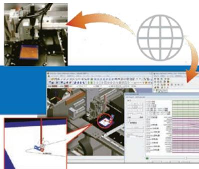
可在CAD上实时显示在线连接的实机运行，也可根据跟踪数据再现运行。即使不在现场，也可远程执行维护和故障排除。
